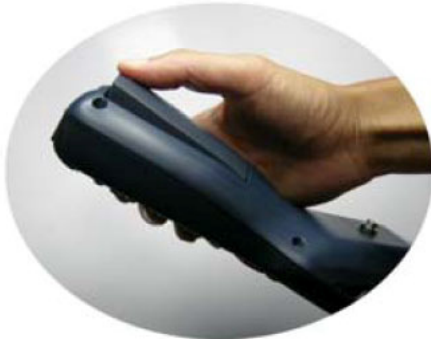
20. ábra A Datalogic Kyman-Gun készülék cserélhető akkumulátorának a készülékbe történő visszahelyezésének utolsó mozzanata
