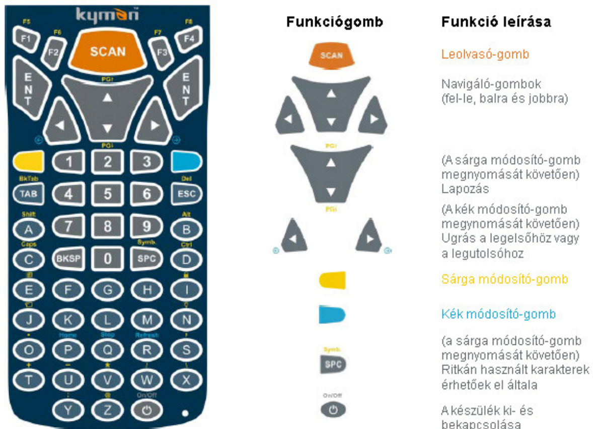
15. ábra (Balról-jobbra) Az 53 gombos billentyűzettel felszerelt Datalogic Kyman-Gun kézi vonalkód-olvasó: klaviatúrája, a funkciógombok, és a hozzájuk tartozó funkció-leírások
