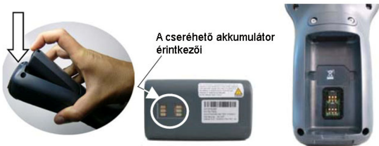
19. ábra A Datalogic Kyman-Gun készülék cserélhető akkumulátorának kivétele
